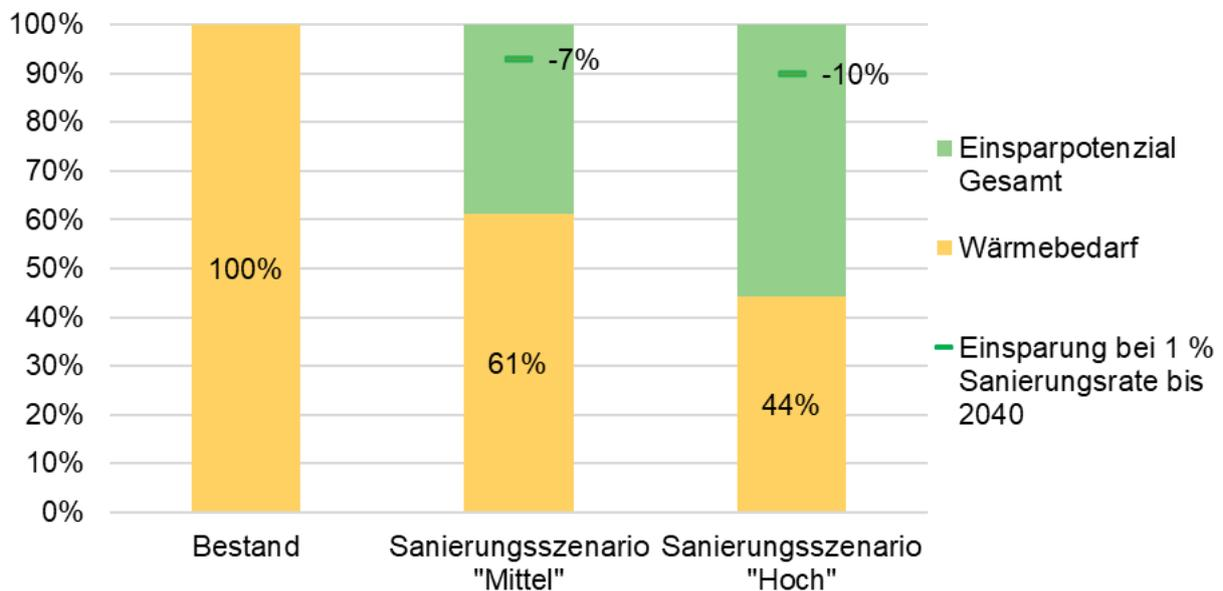
*Abbildung 20: Relatives Einsparpotenzial des Jahresheizwärmebedarfs durch Sanierung.*
