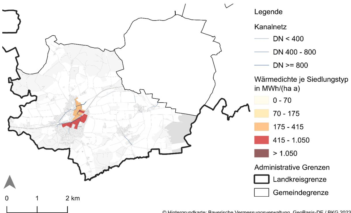
Abbildung 29: Potenzielle Wärmenetzgebiete entlang von Kanälen > DN800.
